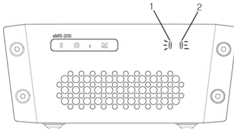
1. 전원 및 상태 표시 램프: 전원 on시 점등되며 동작 상태에 따라 점멸 합니다.
